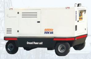
Оборудование обеспечивает безопасное электропитание воздушных судов в условиях агрессивной окружающей среды. Оборудование испытано на заводе AIRBUS в Тулузе на совместимость с самолетами A320, A350 и A380, соответствует ГОСТ Р 54073-2010, ГОСТ 31812-2012, а также европейским стандартам EN 60204-1, ABD100 1.8.1, ISO 6858 and MIL-704.
